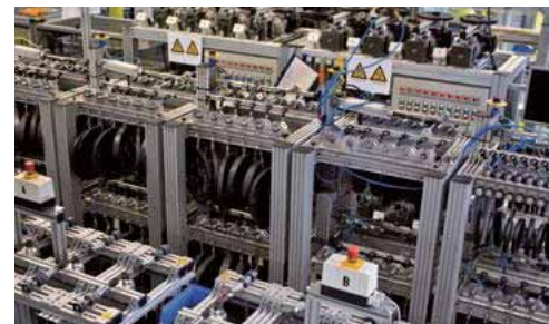
工程塑料轴承技术: 经上千次的测试 ... 模拟真实的环境
