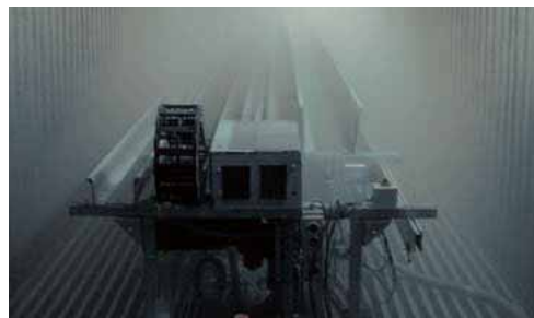
高柔性电缆和拖链在-40 °C的寒冷环境中进行的测试
