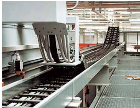
E4拖链系统钢制导向槽长行程应用
